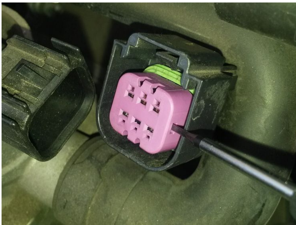
Obr. 1: Boční zámek pro vycvaknutí krytky.
