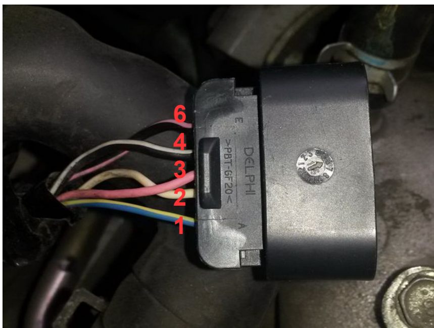
Obr. 5: Očíslování pinů na novém konektoru.
