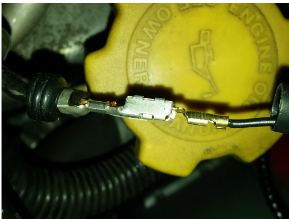
Obr. 13: Napůl zasunutý faston, je vidět jeho orientace vzhledem k protikusu.
