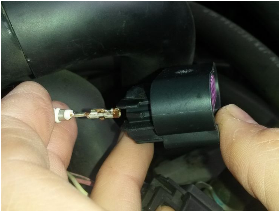
Obr. 6: Správná orientace pinu pro zasunutí.
