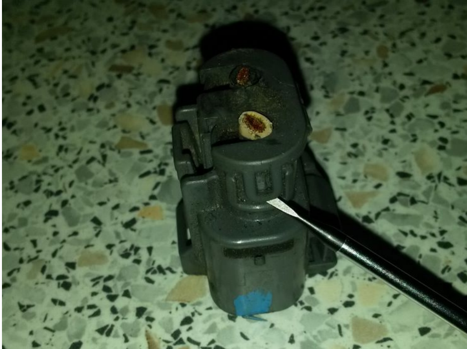
Obr. 8: Západka zajištění kabelů.
